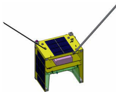
Rys. 8. System antenowy, przejście przez ścianę satelity
